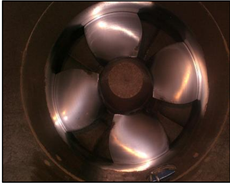
Şekil 3.2. Yatay eksenli kaplan tipi türbin
