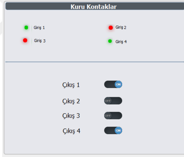
Şekil 4.2. Kuru kontak giriş çıkış kontrolü.
