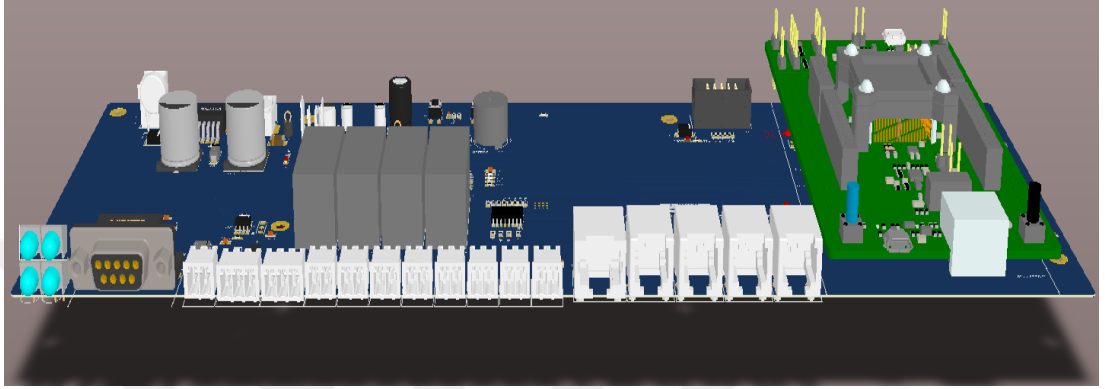
Şekil 3.25. Kontrol kartının üç boyutlu tasarım görseli.
