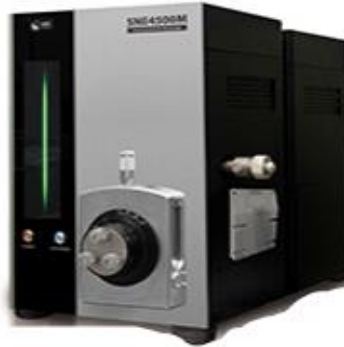
Şekil 3. 4 : EDS analiz cihazı.
