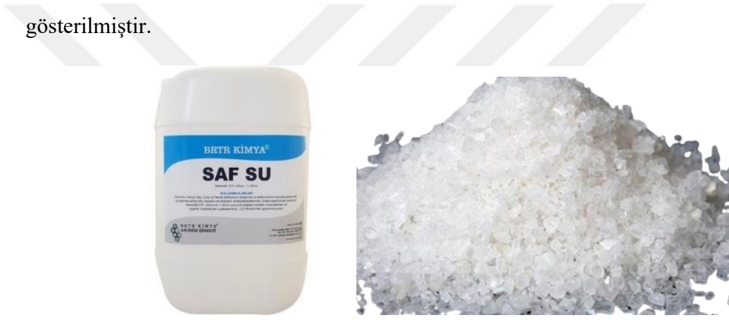
Şekil 3. 11 : Korozyon test kiti ( saf su ve tuz).
