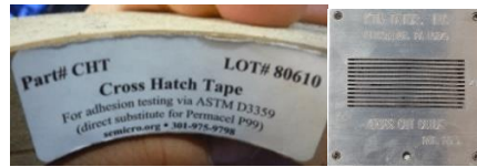
Şekil 2. 24 : Kareleme test bandı ve kesme kalıbı.
