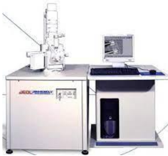
Şekil 3. 8 : JEOL JSM 6060 LV markalı SEM cihazı.
