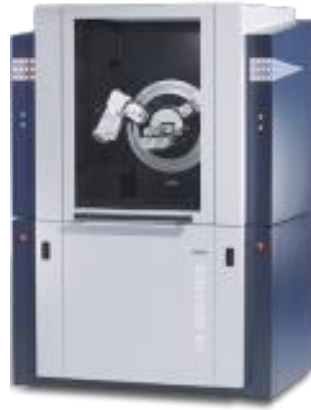
Şekil 3. 3 : Bruker marka XRD cihazı.
