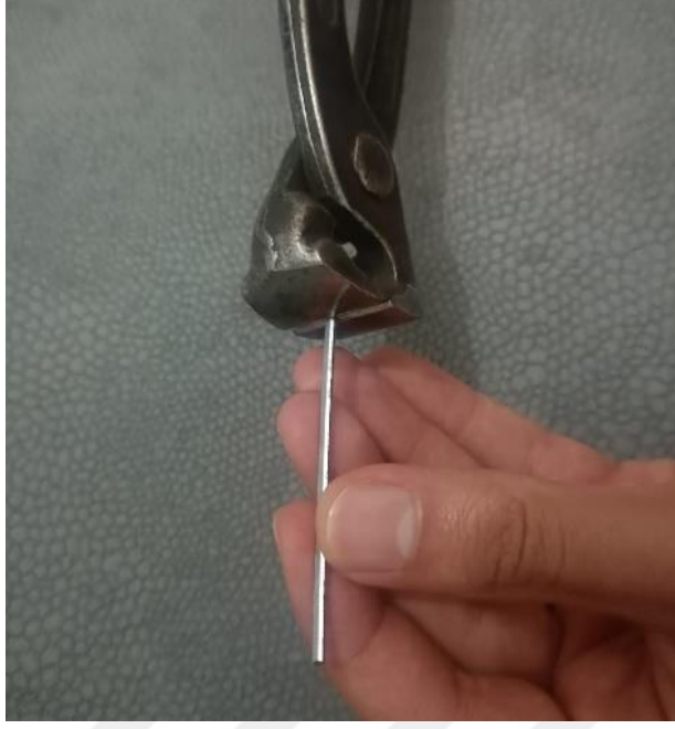
Şekil 3.5: Numunelerin gerekli uzunlukta kesilmesi
