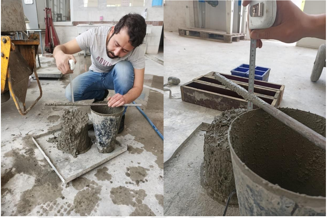
Şekil 3.11: Betonda çökme (slump) deneyi
