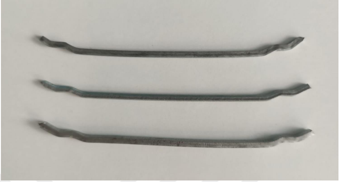
Şekil 3.8: Atk lifin öncesi ve sonrası
