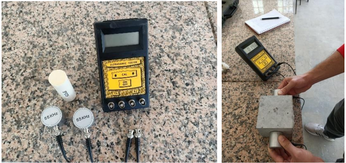
Őekil 3.12: Ultrases geiş hızı deneyi
