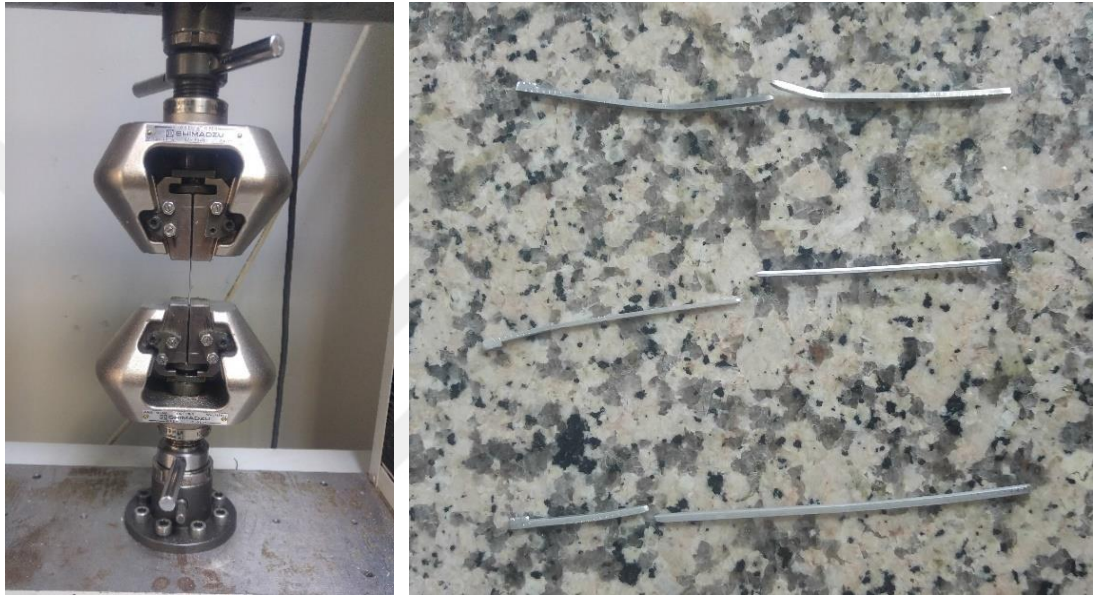
Şekil 3.10: Atık liflerin çekme deneyi sırasında ve sonrasındaki halleri
