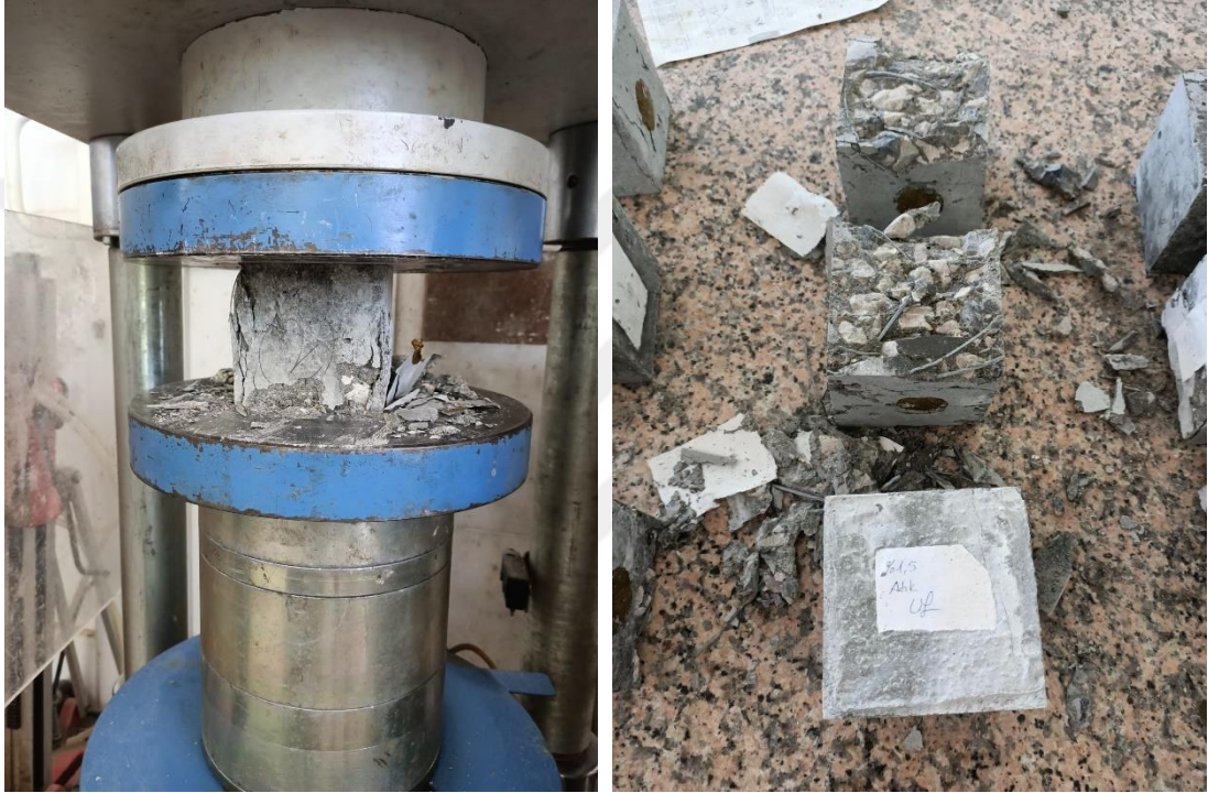
Şekil 3.13: Beton numunelerin basınç dayanımı ve sonrasındaki halleri
