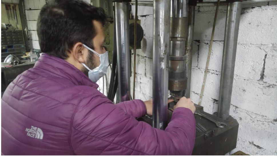
Şekil 3.6: Numunelerin preslenip uygun forma getirilmesi
