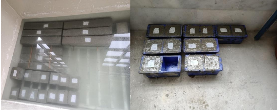
Şekil 3.9: Numunelerin kalıplara yerleştirilmesi, kalıplardan sökülmesi ve kür havuzuna yerleştirilmesi
