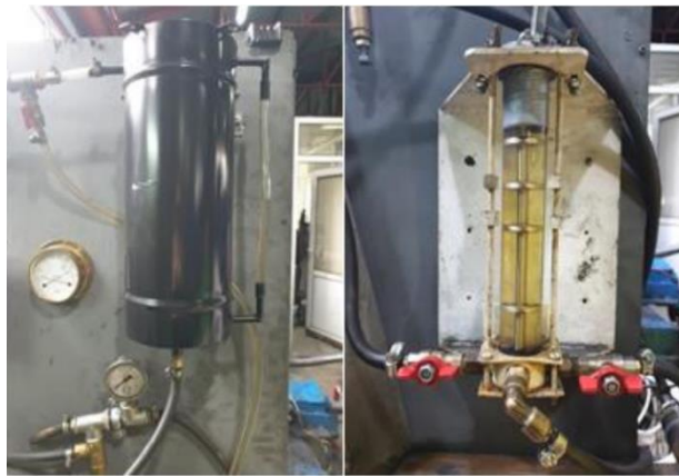
Şekil 4.4. Yakıt tankı ve yakıt ölçüm tüpü
