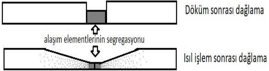
Şekil 4.2 : Döküm ve döküm sonrası ısıl işlem görmüş numunelerde segregasyon değişiminin dağlamaya etkisinin şematik gösterimi.
