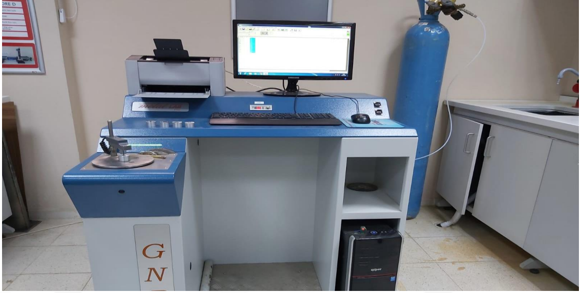
Şekil 3.6 : S7 METAL LAB Plus metal analiz spektrometre cihazı.
