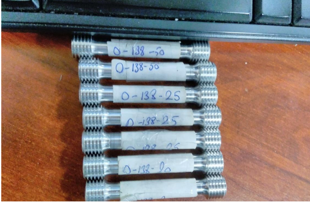
Şekil 3.8 : DIN 50125 Type B standartı çekme testi numunesi.
