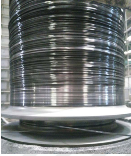
Şekil 6.1 : %50 silindir boyu ile hazırlanmış 12 derece 1,63 mm çapında haddeden geçmiş telin bloktaki görüntüsü.
