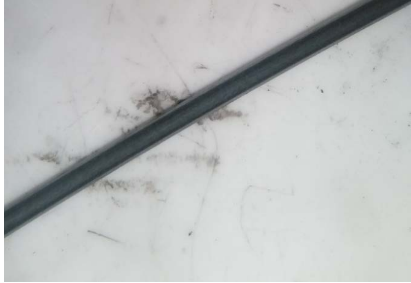
Şekil 6.6 : Silindir boyu %35 olan 1.63 mm haddeden çekilen telin makro görüntüsü.
