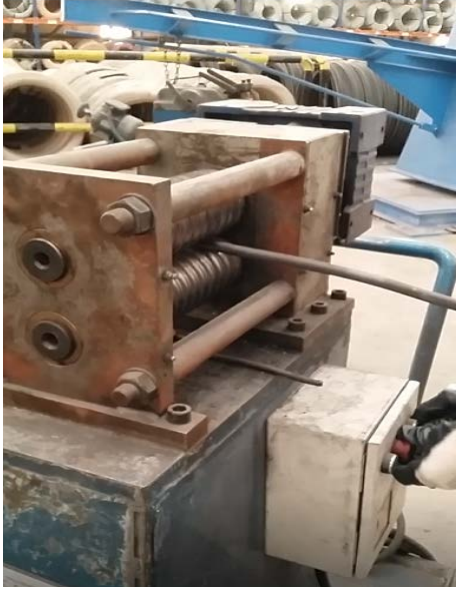
Şekil 1.3 : Uç açma ve haddeden geçirme.
