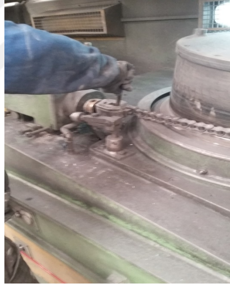
Şekil 1.3 : Uç açma ve haddeden geçirme.
