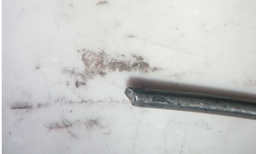
Şekil 4.3 : 2,20 mm fosfat kaplı SM kalite telde hadde kaynaklı hasarlı ve sünek kopma yüzeyi.
