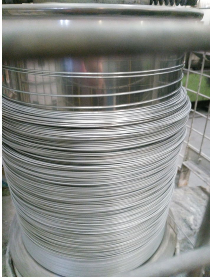
Şekil 6.19 : 9 derece ile çekilen galvanizli 1,63 mm telde uygun sabunlu mat yüzey
