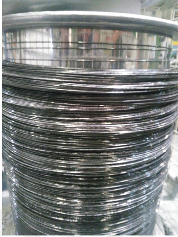
Şekil 4.1 : Hadde kaynaklı fosfat kaplaması soyulan tel örneđi.
