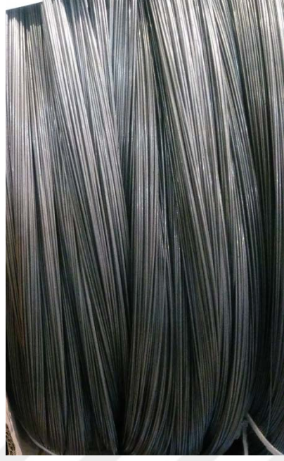
Şekil 6.8 : %30 silindir boyuna sahip 1,10 mm hadde ile çekilen tel görüntüsü.
