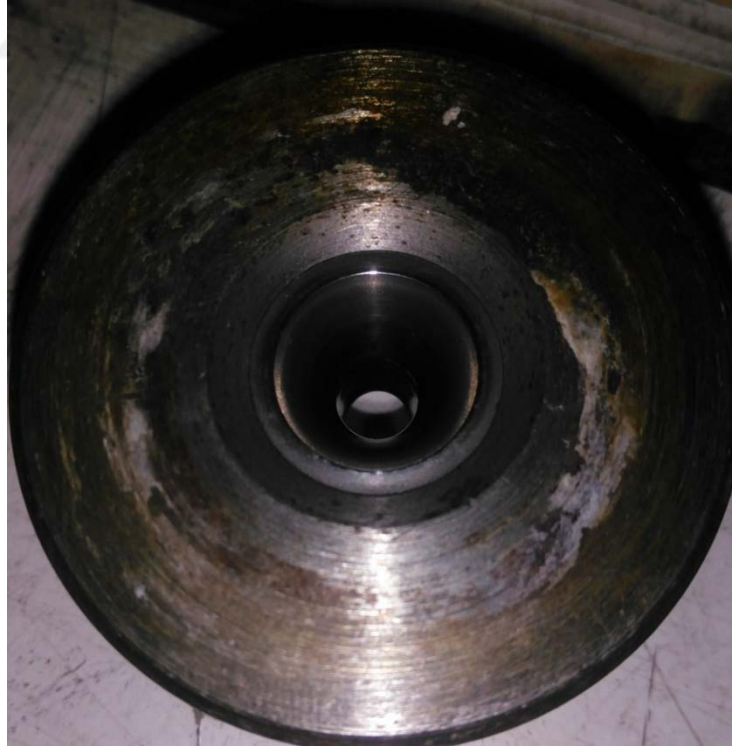
Şekil 4.2 : Geometrisi bozuk hadde örneđi. (Silindiri aşırı uzun, açısı çok geniş).
