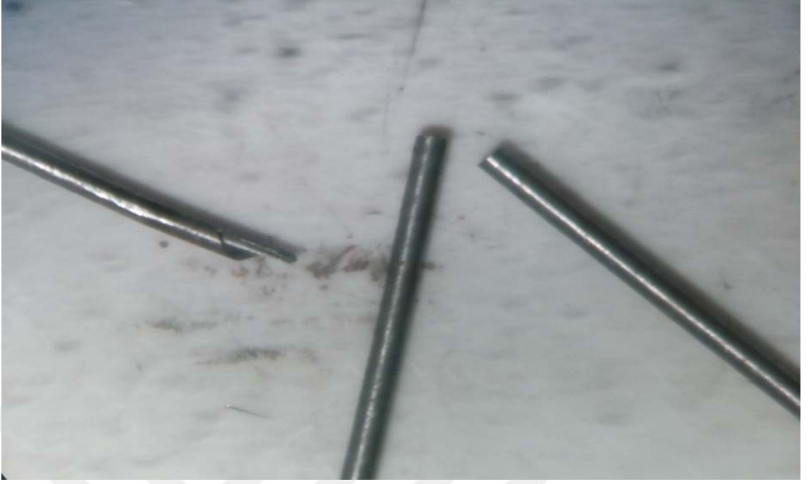
Şekil 6.12 : % 50 silindir boyuna ait haddeden çekilmiş telin makro görüntüsü.
