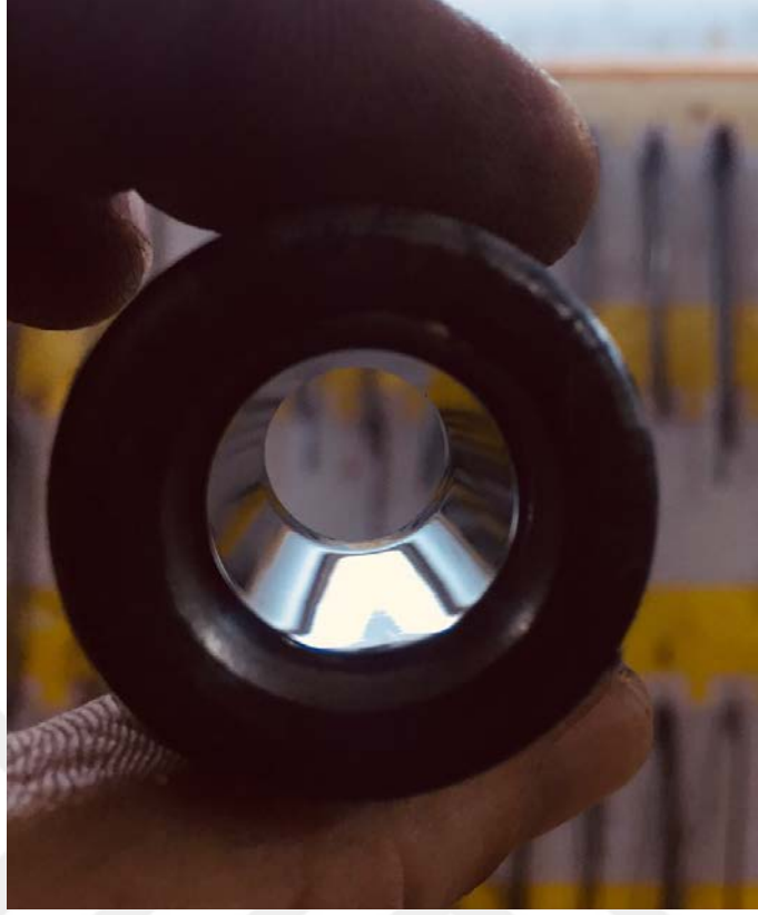
Şekil 3.5 : Parlatılmış ve temizlenmiş imalata hazır hadde.
