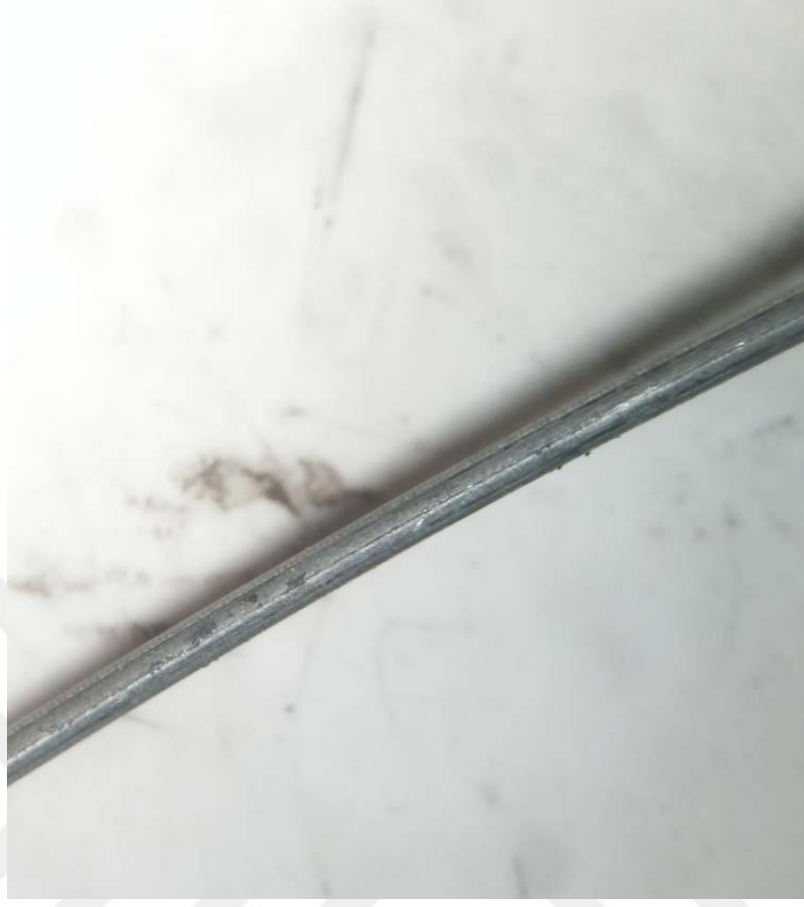
Şekil 6.5 : Silindir boyu %50 olan 1.63 mm haddeden çekilen telin makro görüntüsü.
