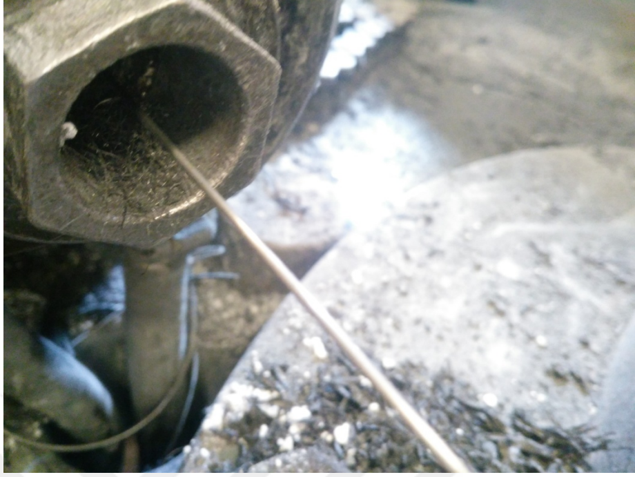
Şekil 6.3 : Silindir boyu %50 olan haddenin tel çekme işleminde hadde çıkışında fosfat sıyırması.
