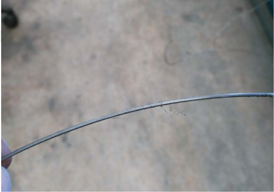
Şekil 6.4 : Silindir boyu %50 olan 1.63 mm haddenin çekilmiş tel görüntüsü.
