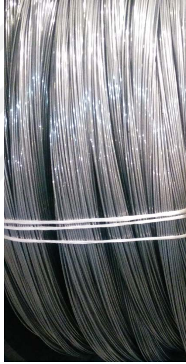
Şekil 6.7 : %50 silindir boyuna sahip 1,10 mm hadde ile çekilen tel görüntüsü.
