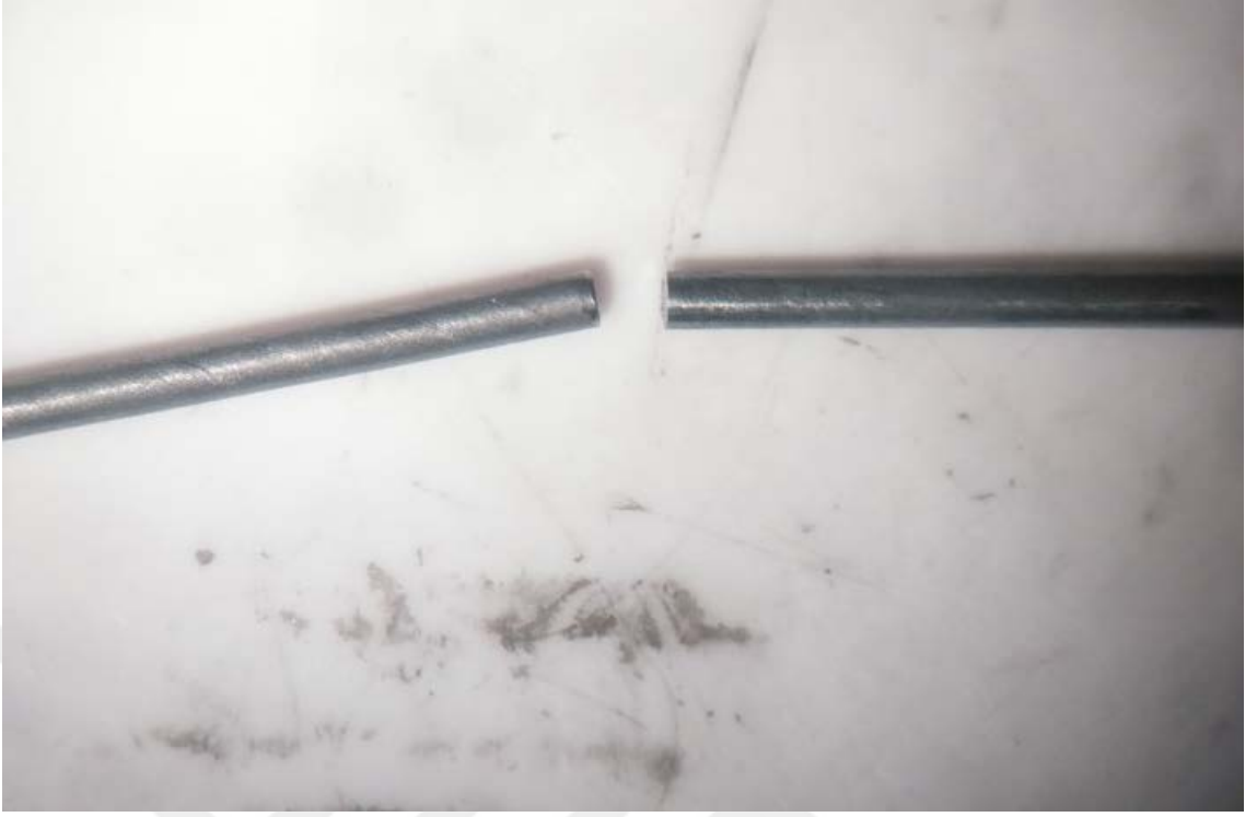
Şekil 6.14 : % 30 silindir boyuna ait haddeden çekilmiş telin makro görüntüsü.
