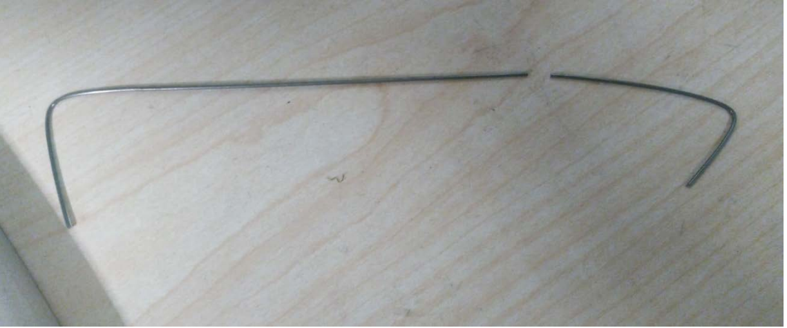
Şekil 6.13 : % 30 silindir boyuna ait haddeden çekilmiş telin görüntüsü.
