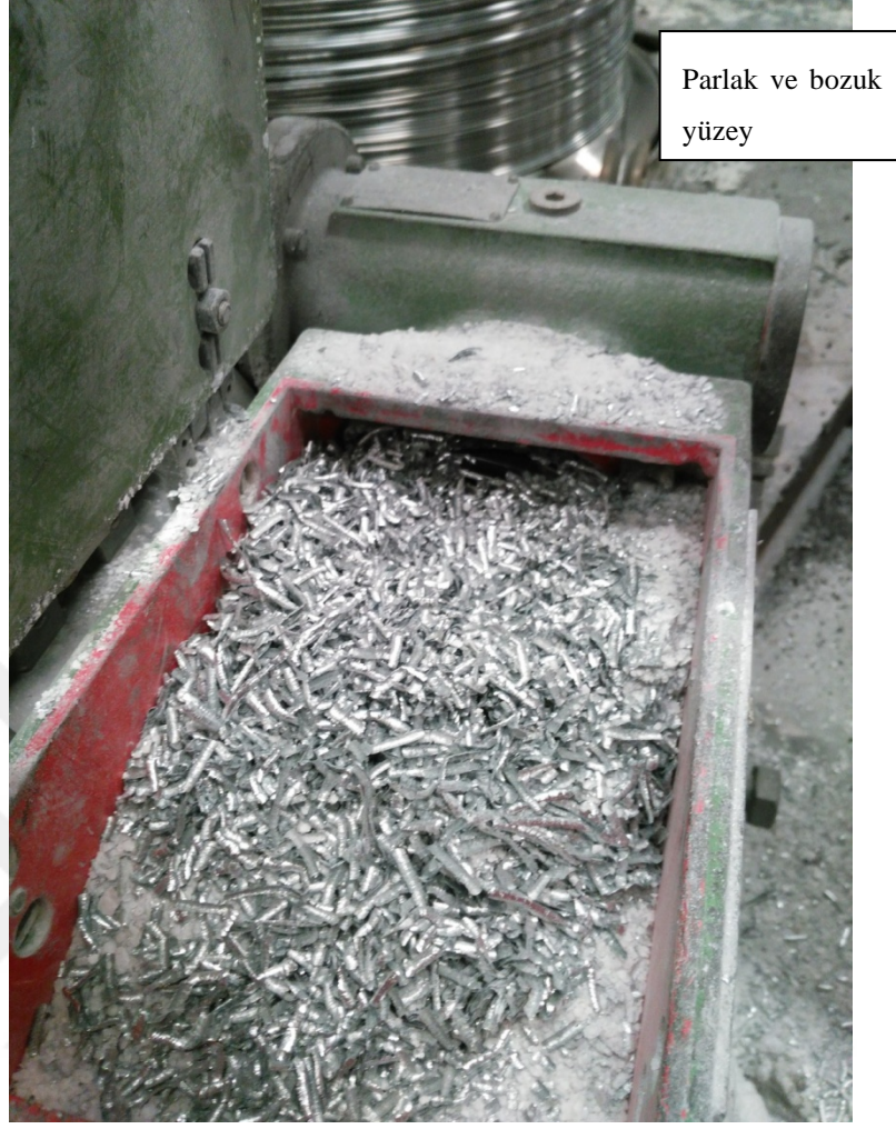
Şekil 6.20 : 12 derece hadde ile çekilen galvanizli 1,63 mm telde çinko çapaklanması ve yüzey bozukluğu
