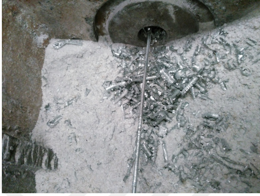
Şekil 4.4 : Hatalı hadde geometrisi kaynaklı yüksek karbon tellerde çinko sıyırılması.
