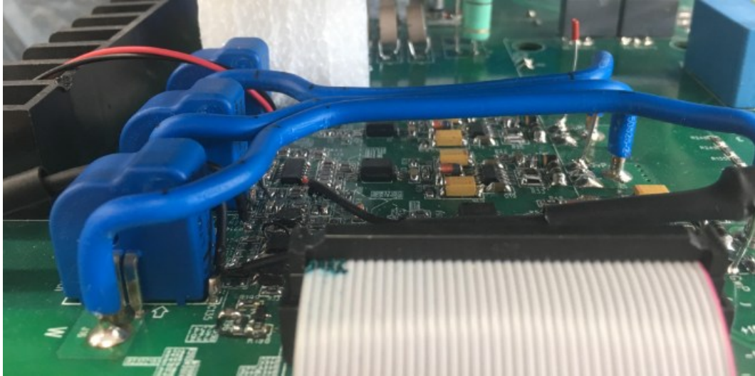
Şekil 4.8 : Alan etkili sensör ile motor faz akımını ölçümünün test düzeneği
