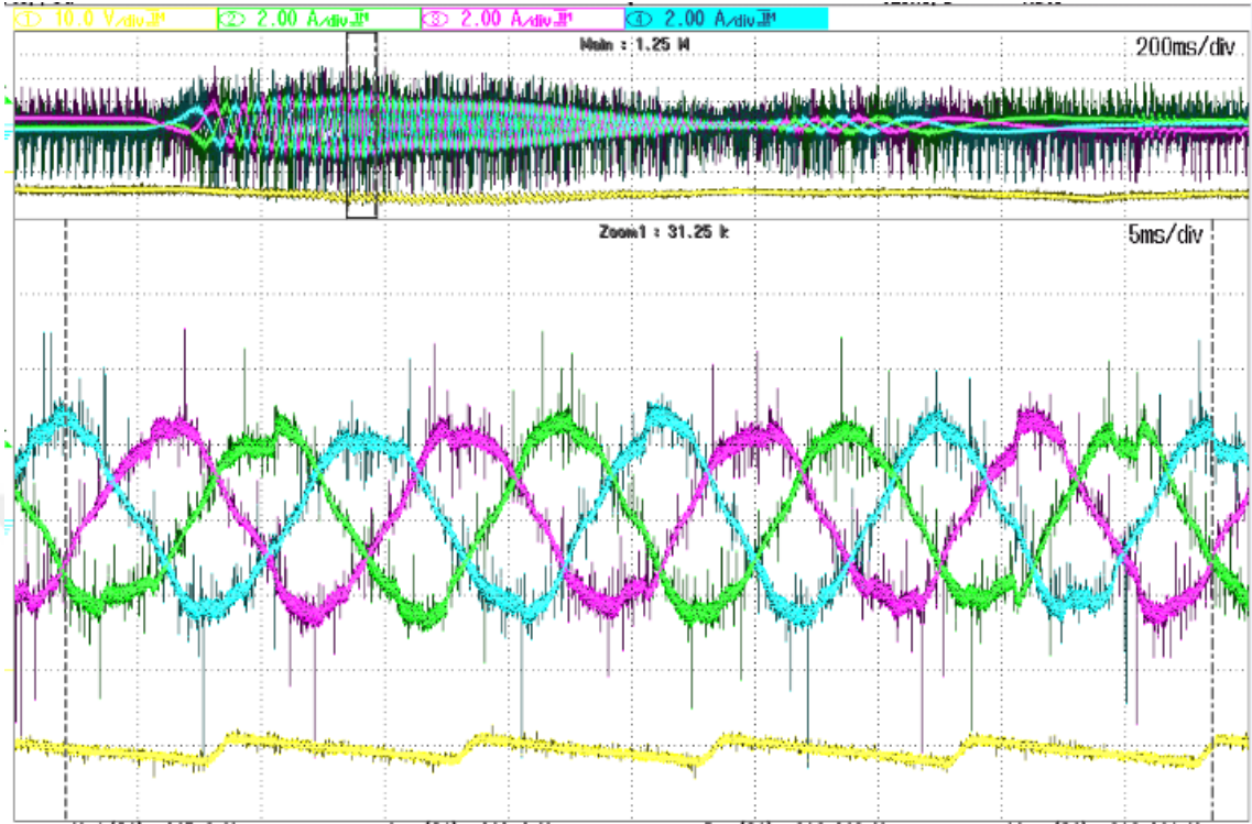
Şekil 4.2 : Şönt direnç ile ölçülen motor akımlarının görüntüsü.
