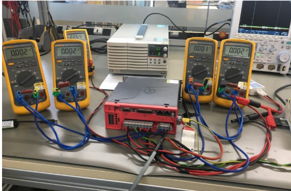
Şekil 4.5 : Şönt direnç ile motor akımı ölçümünün test düzeneği.
