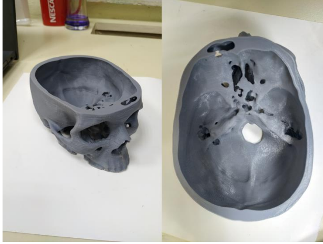
Şekil 4.4. Uygulamadan elde edilen 3B modelin 3B baskısı
