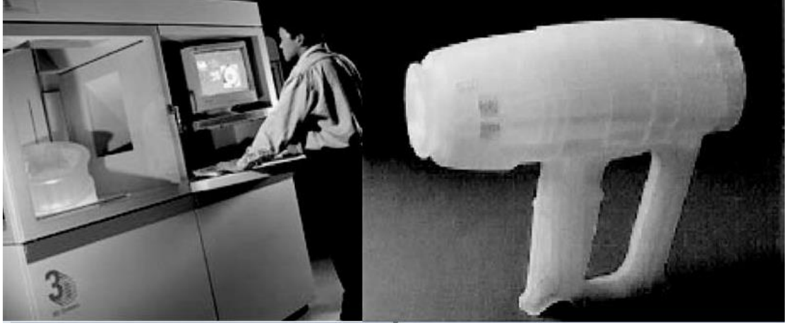
Şekil 2.57. Tipik bir stereolithography cihazı ve bu yöntemle üretilmiş bir ürün (Gibson, 2005, s. 6)
