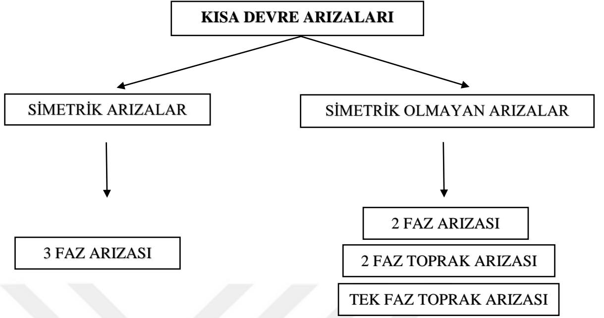
Şekil 2. 1 : Şebekelerde meydana gelen kısa devre arızaları.
