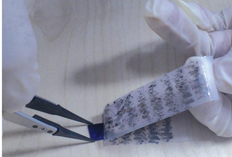
Şekil 3.4 : Mekanik eksfoliasyon tekniği ile tek katmanlı grafen eldesi [71].
