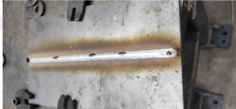
Şekil 3. 14 : Darbeli akımla yapılmış kaynak dikişi.
