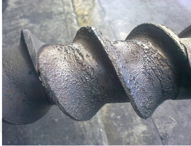
Şekil 2.7 : Korozif aşınma örneği [23]
