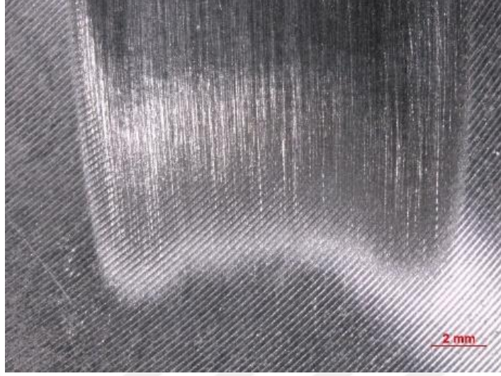
Şekil 3.24 : Isıl işlemsiz 4140 çeliği aşınma izi görüntüsü
