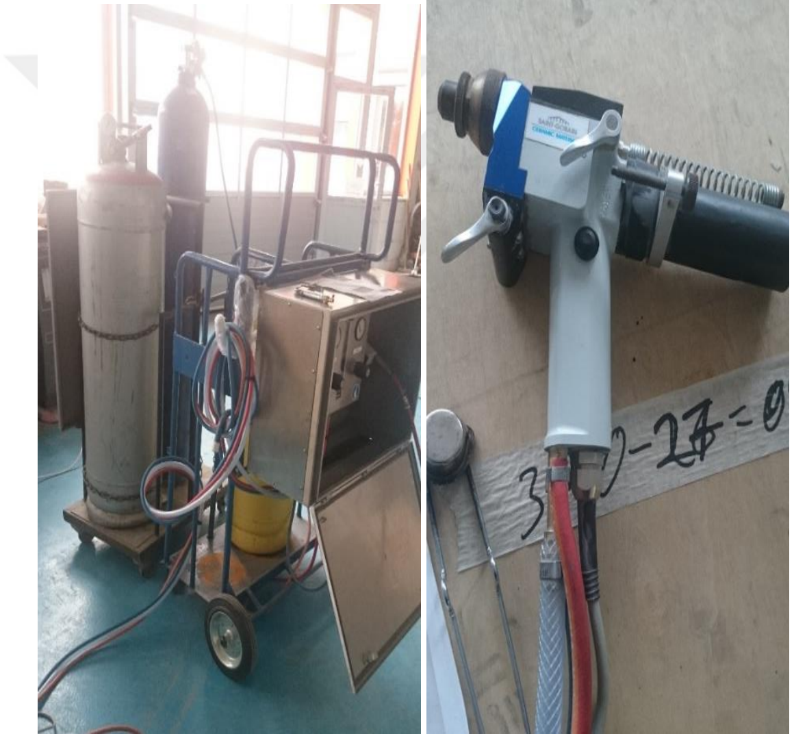
Şekil 3.4 : Alev sprej gaz ünitesi- Alev sprej tabancası
