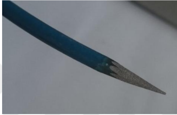
Şekil 3.5 : NiCr kaplaması sonrası flexicoard ucu yapısı
