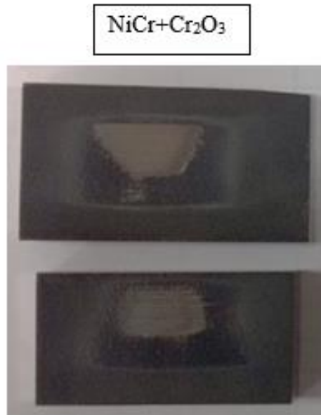
Şekil 3.11 : Yapılan kaplamaların aşınma sonrası fotoğrafları
