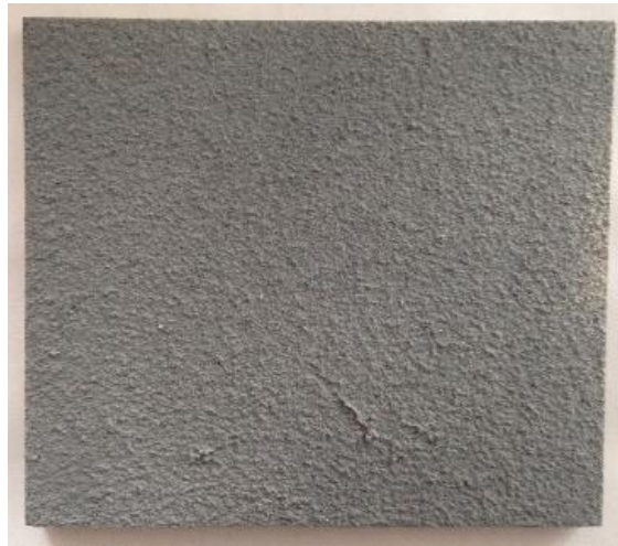
Şekil 3.8 Cr 2 O 3 tabakası uygulanmış numune
