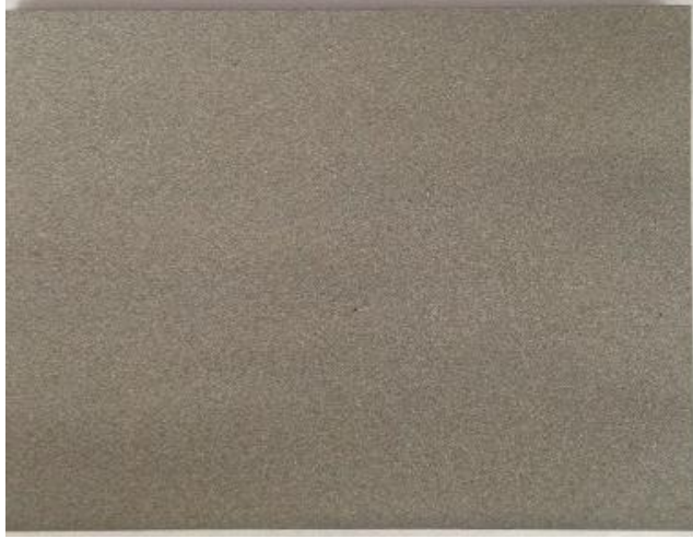
Şekil 3.7 : NiCr bağ tabakası uygulanmış numune
