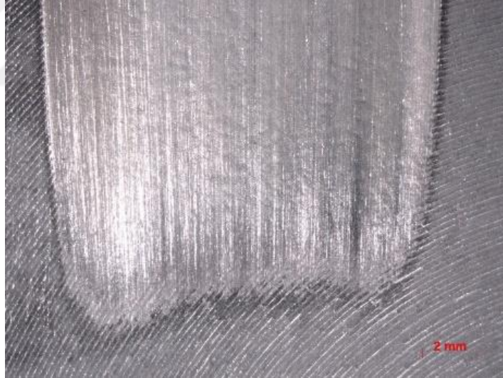
Şekil 3.25 : Isıl işlemlili 4140 çeliği aşınma izi görüntüsü
