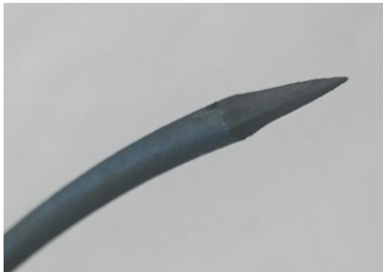
Şekil 3.6 : Cr 2 O 3 kaplaması sonrası flexicoard ucu yapısı
