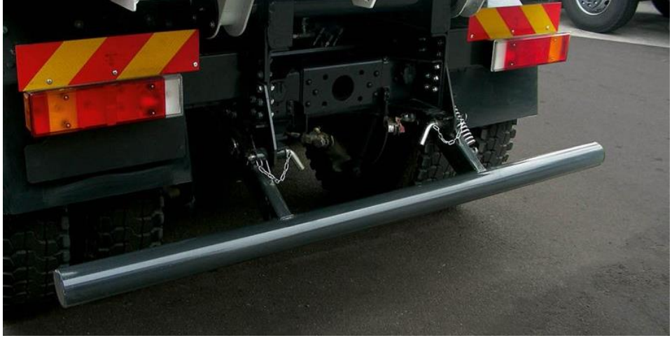
Şekil 2.2: Ağır ticari taşıtlarda kullanılan “Yuvarlak” formlu arka tampon.
