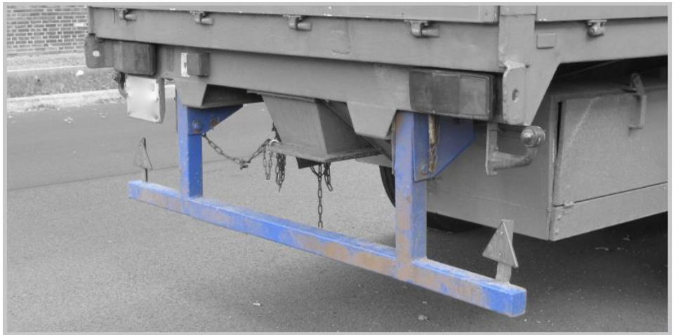
Şekil 2.4: Ağır ticari taşıtlarda kullanılan “Kare” formlu arka tampon.
