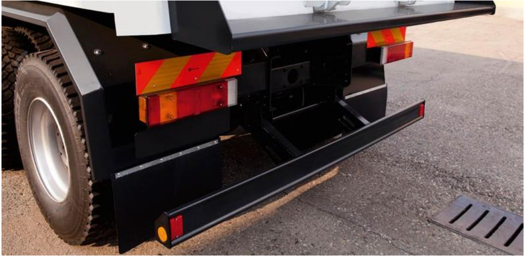
Şekil 2.1: Ağır ticari taşıtlarda kullanılan “Özel” formlu arka tampon.
