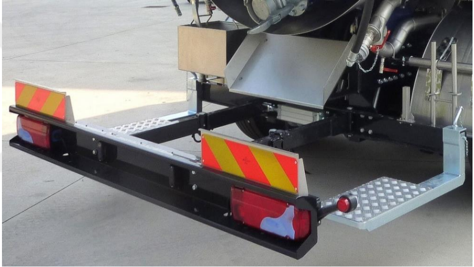
Şekil 2.3: Ağır ticari taşıtlarda kullanılan “C Tipi” formlu arka tampon.
