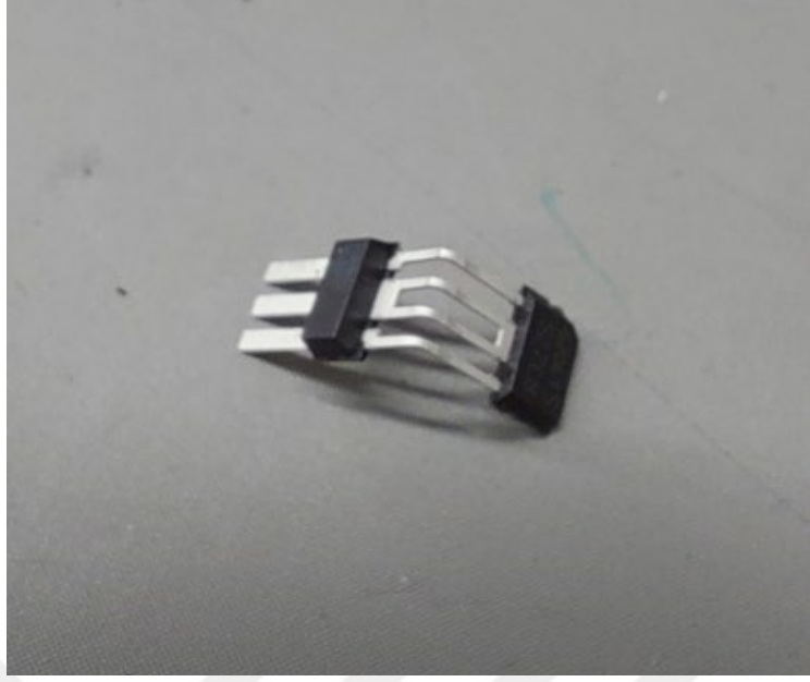
Şekil 7.3: Üç ayaklı Hall etkisi sensörü, Kalay kaplı Bakır Nikel Alaşım.
