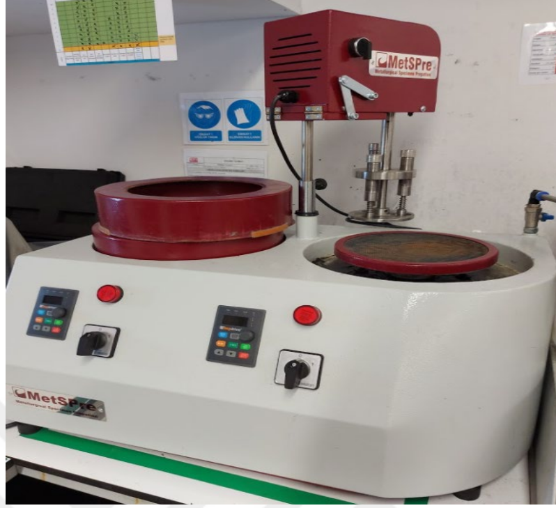
Şekil 7.9: Yüzey Parlatma Ekipmanı: MetSPre , 100-1380 rpm.
