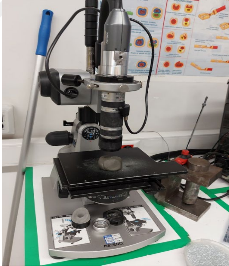
Şekil 7.10: Dijital Mikroskop- Keyence VHX-2000 , 100-1000 dijital büyütme.
