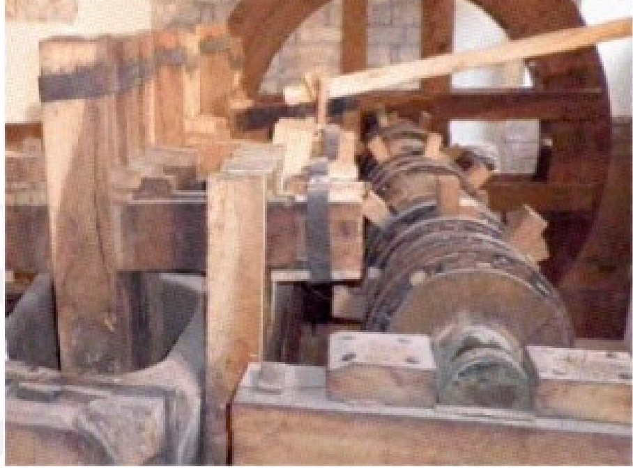
Şekil 2.2 Vanoccio Biringuccio'un kağıt mili kam mekanizması (Meneghetti ve Maggiore, 2011).
