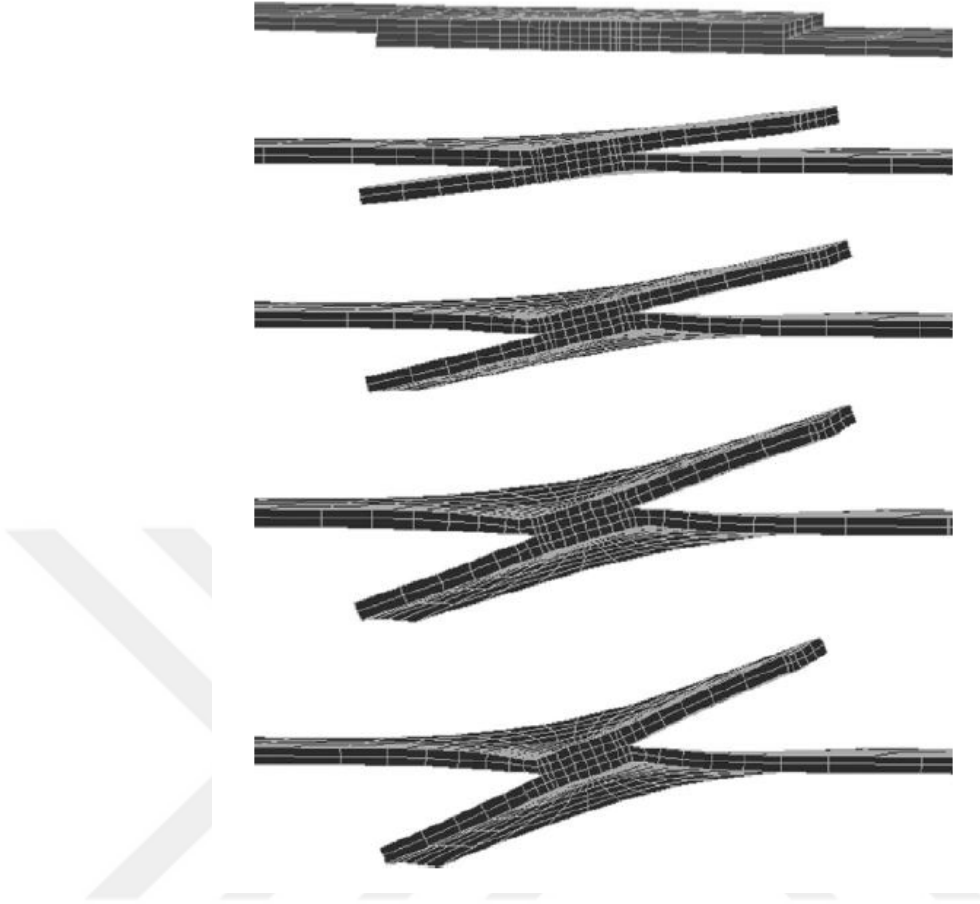
Şekil 5.4: Çekme testi sırasında şekil değıştirme eğilimi.
