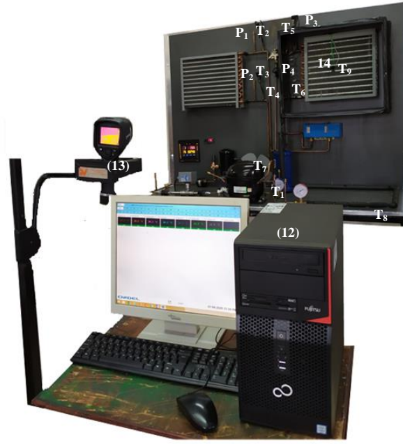
Şekil 3.5. Deney düzeneğinden termal kamera ile görüntü alınma işlemi.
