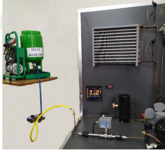
Şekil 3.6. Deney düzeneği soğutucu akışkan vakum ve şarj işlem düzeneği.
