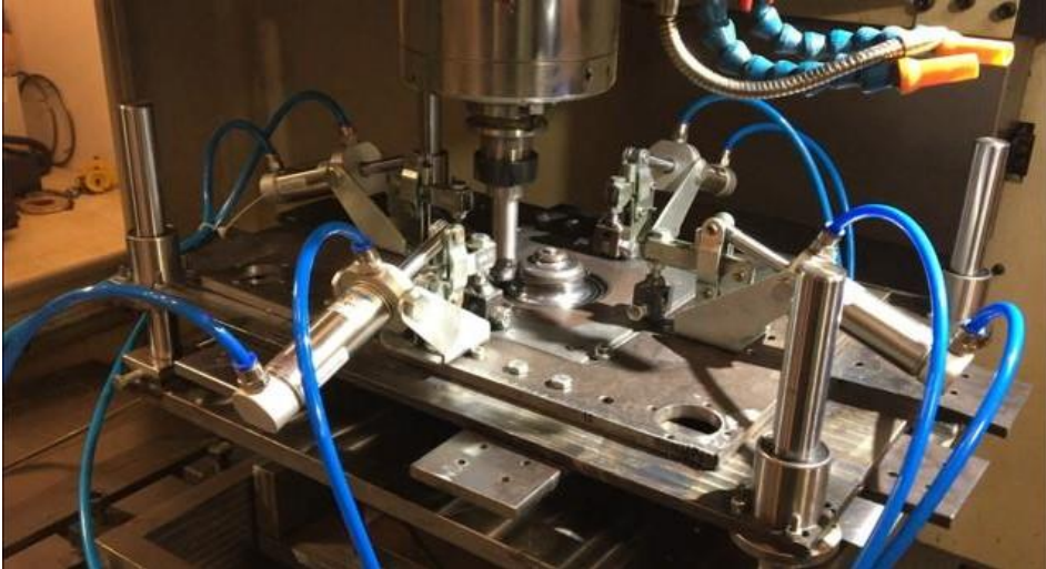
Şekil 4.47 : Amortisör yay sacı gövde bölgesinin şekillendirilmesi.
