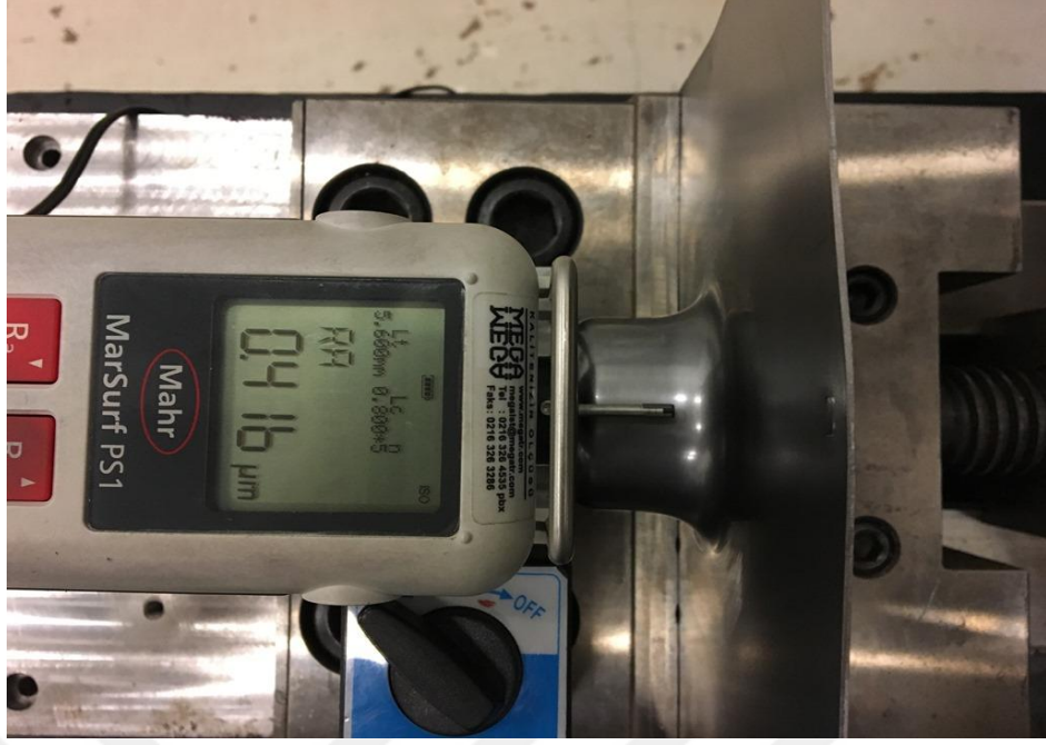
Şekil 3.22 : Farklı açıdan yüzey pürüzlülüğü ölçüm anı.
