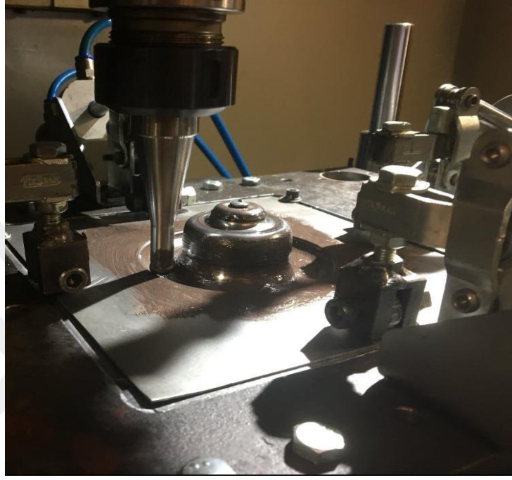
Şekil 4.48 : Amotrisör yay sacı negatif faturanın şekillendirilmesi.
