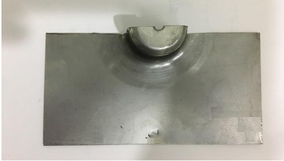
Şekil 3.16 : Et kalınlığı ölçümü için kesilmiş deney parçası.
