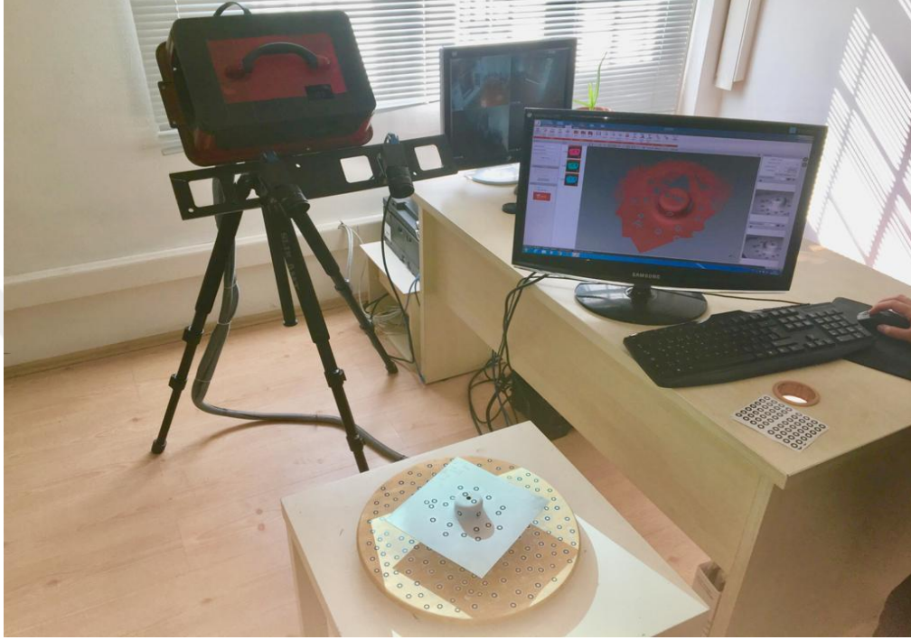
Şekil 3.26 : Optimizasyon parçalarının 3D tarama anı.
