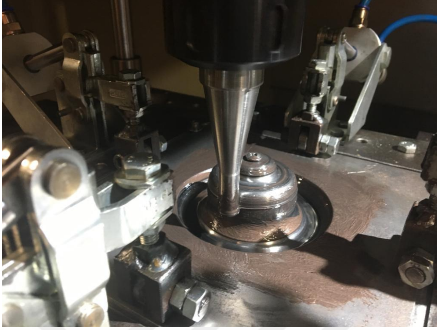
Şekil 4.49 : Amortisör yay sacı dördüncü adımın şekillendirilmesi.
