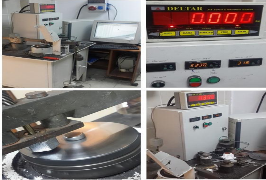
Şekil 3.10. Pin-on disk aşınma test cihazının görünümü
