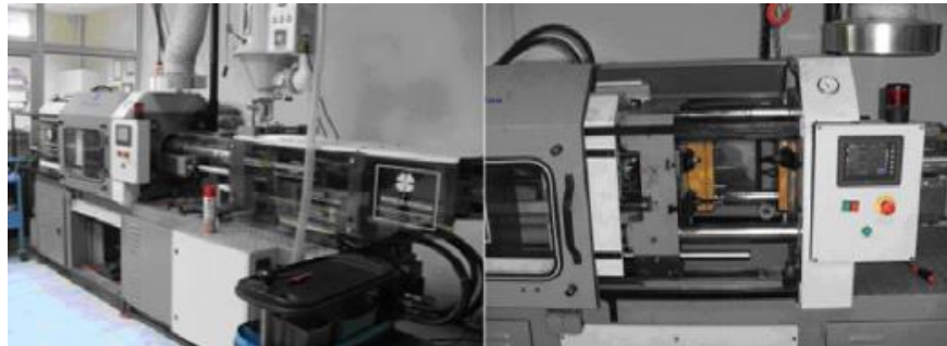
Şekil 3.2. Plastik enjeksiyon makinası
