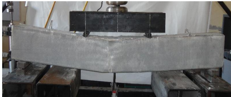
Şekil 2.7. FRP kompozitin kopması.
