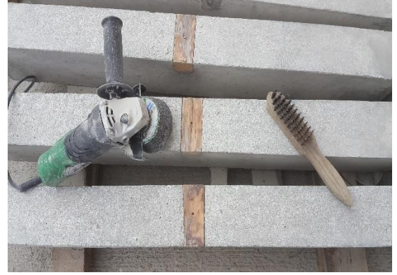
b) Tel fırça ve taşlama makinesi
