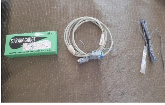
a) Strain gauge ve veri aktarım ekipmanları
