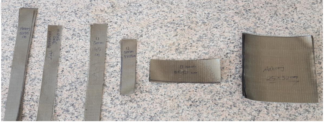
c) Deneyde kullanılan BFRP kumaş örnekleri
