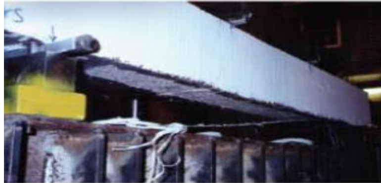
Şekil 2.5. FRP kompozit uygulanan kirişte plaka ucu ayrılması.
