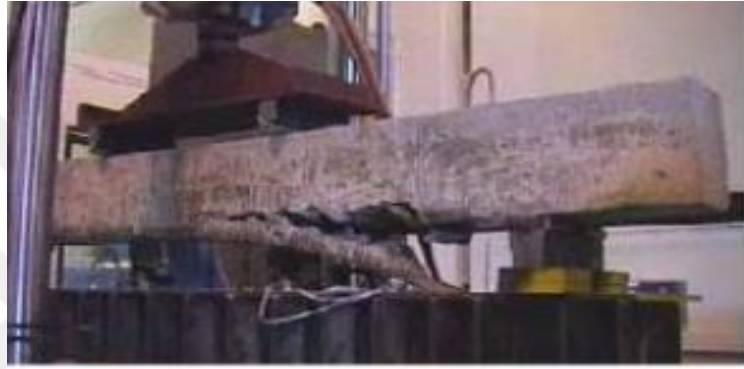
Şekil 2.6. FRP kompozitin paspayı ile yüzeyden ayrılması.
