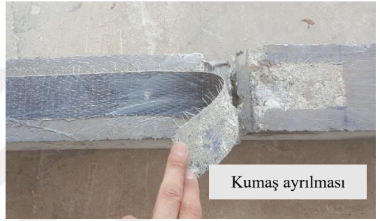
b) MY10 numunesinde oluşan kumaş ayrılması
