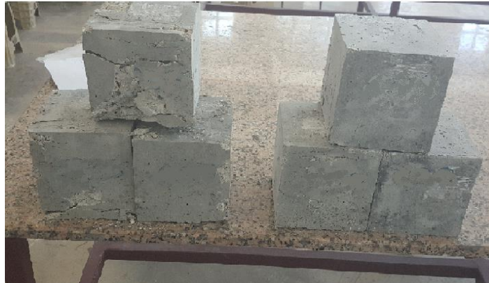
Şekil 3.1. Küp beton numuneleri.
