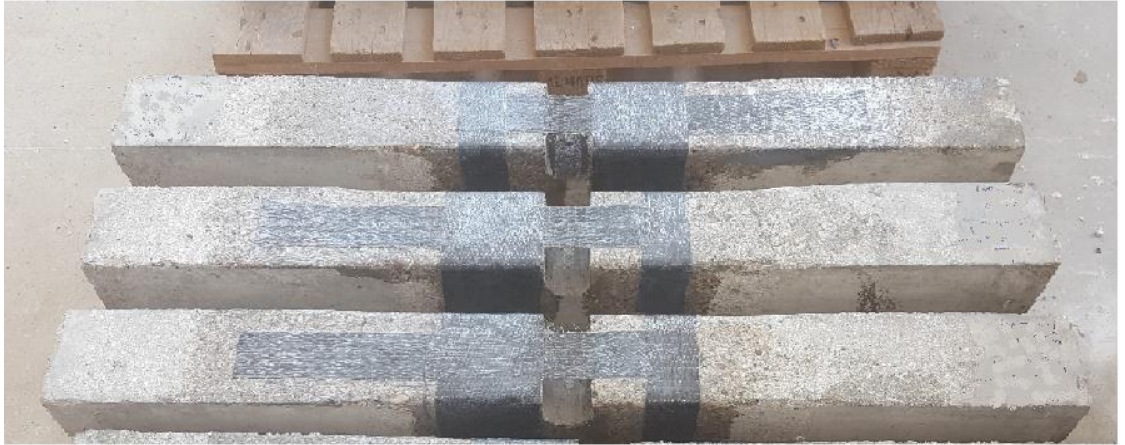
Şekil 3.17. U sarım uygulaması yapılan deney numunelerinin hazırlanması.
