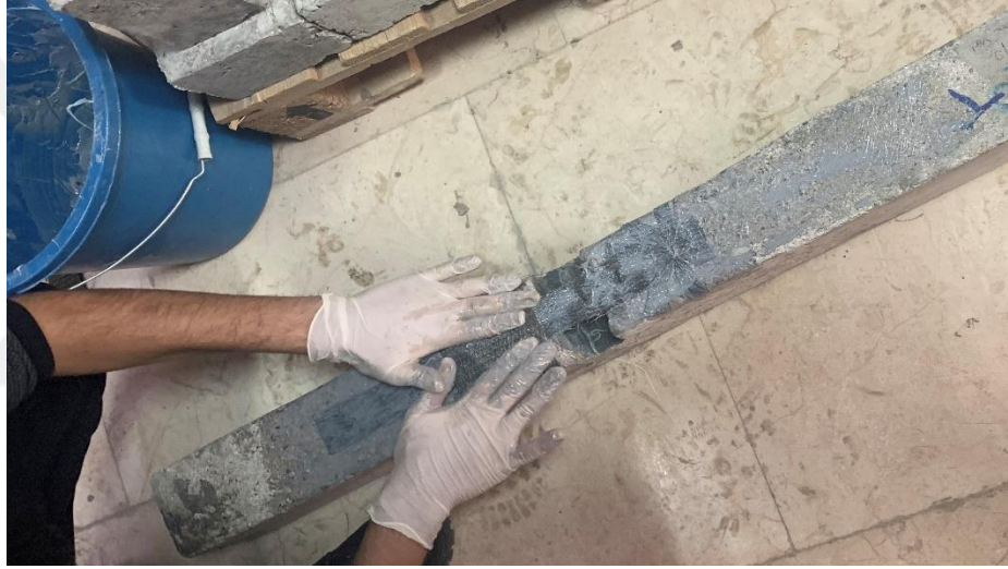
c) Fan ankraj uygulaması tamamlanan deney numunesi
