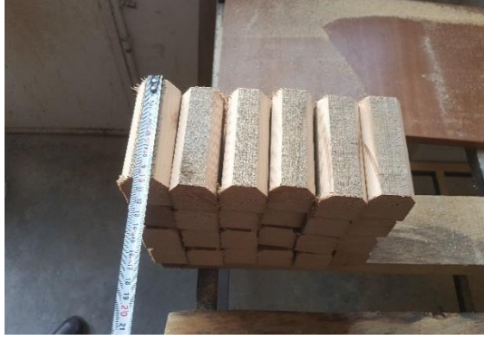
a) Kiriş simetri eksenine yerleştirilen ahşap
