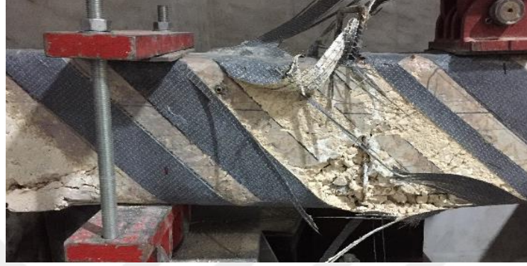
Şekil 2.4. FRP kompozit uygulanan kirişte kesme kırılması.
