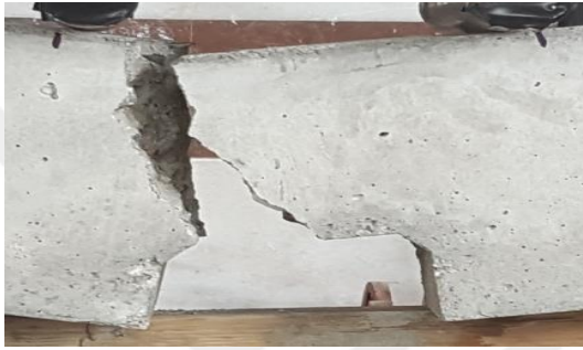
a) Kontrol kirişinde oluşan deformasyon
