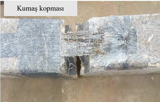
e) YDF10 numunesinde oluşan kumaş kopması
