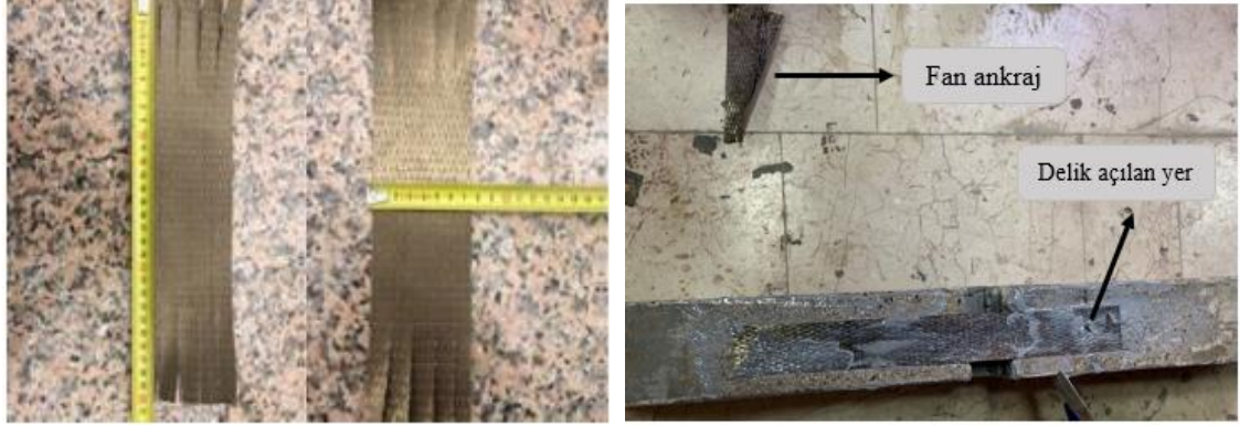
a) Ankraj uygulamasında kullanılacak elyafın boyutları
