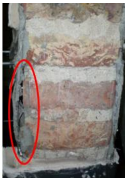
b) Duvarlarda görülen FRP ayrılması
