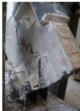
b) Duvarlarda görülen FRP ayrılması
