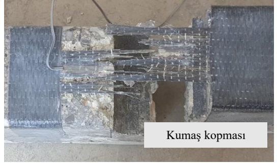
d) YDU10 numunesinde oluşan kumaş kopması
