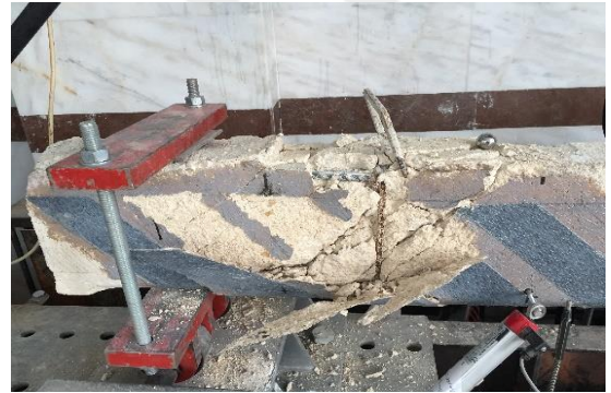
a) Kirişlerde görülen FRP ayrılması
