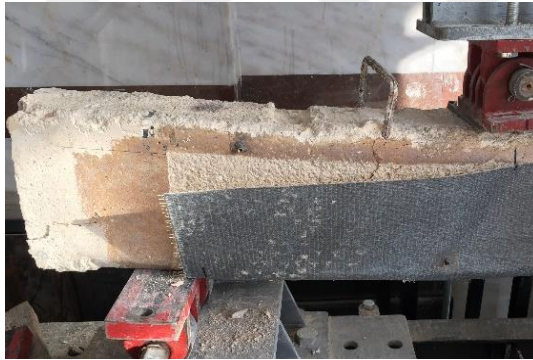
a) Kirişlerde görülen FRP ayrılması
