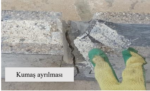
c) YD10 ,YD15 ve YD20 numunelerinde oluşan benzer kumaş ayrılması
