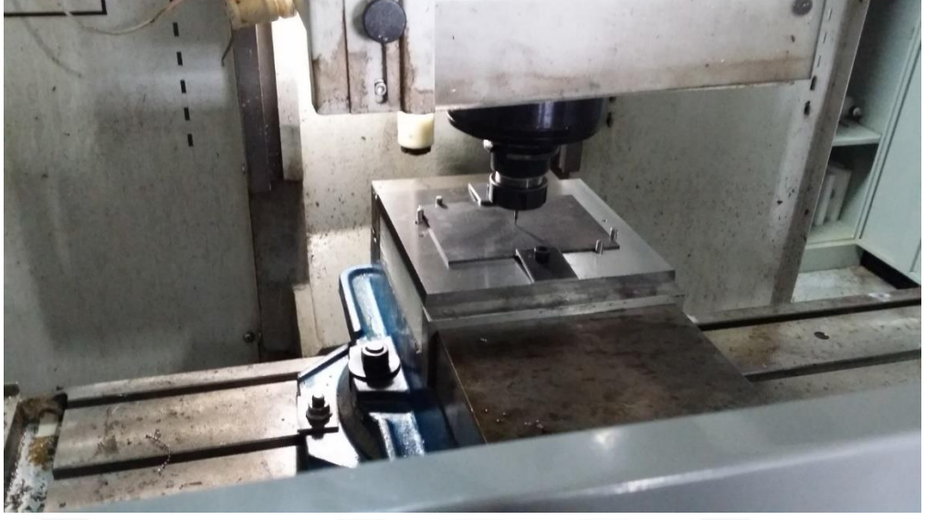
Şekil 4.3 : Grafit plakaların işlenmesi.
