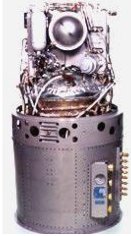
Şekil 2.3 : Apollo uzay aracının 1,5 kW yakıt hücresi yığını.
